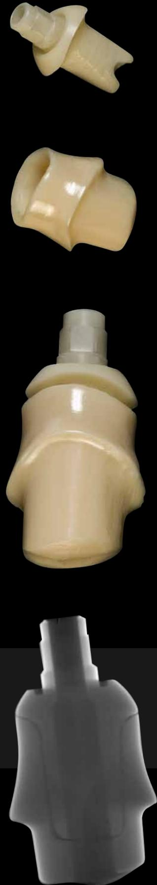
Die Evolution eines Implantatpfostens bis hin zur Kontrolle der Passgenauigkeit durch ein Mikro CT. Diese Kontrollverfahren stehen momentan ausschließlich großen Forschungszentren zur Verfügung
